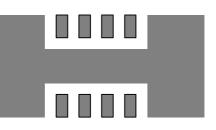
(d) Copper Area =  $50 \text{ mm}^2$ ,  $\theta_{\text{JA}} = 51^{\circ}\text{C/W}$
